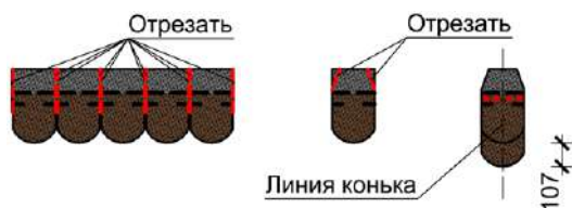
Рис. 32. Устройство рёбер скатов и коньков при помощи рядовой черепицы.
