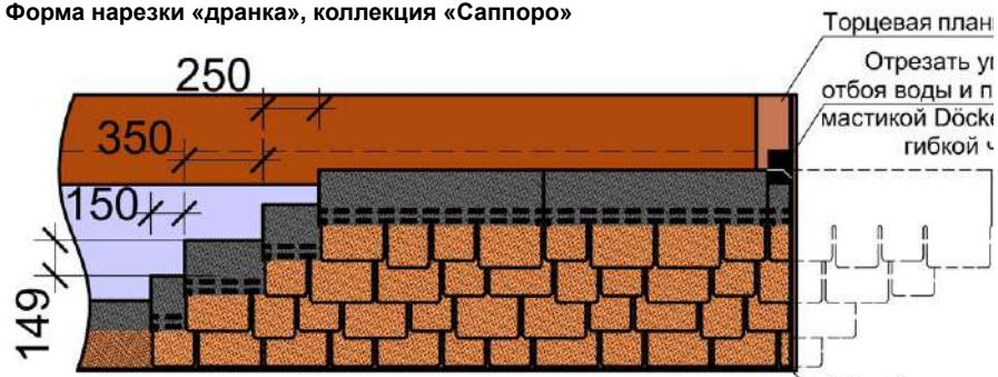
Рис. 24. Схема смещения гонтов по горизонтали и вертикали.
